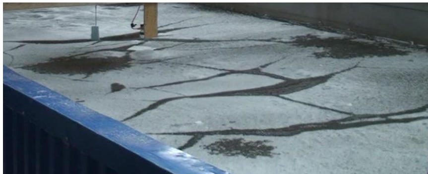
Рис. 5. Характер разрушения модельного льда толщиной 3 мм после прохождения модели эллипсоидной формы со скоростью u_m=2.05 м/с
