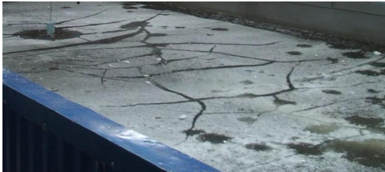
Рис. 3. Характер разрушения модельного льда толщиной 3 мм после прохождения модели со сложной формой геометрии корпуса со скоростью u_m=2.08 м/с
