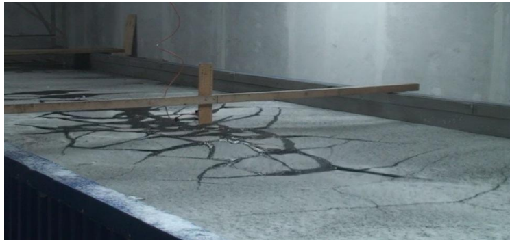
Рис. 4. Характер разрушения модельного льда толщиной 3 мм после прохождения модели каплевидной формы со скоростью u_m=2.05 м/с
