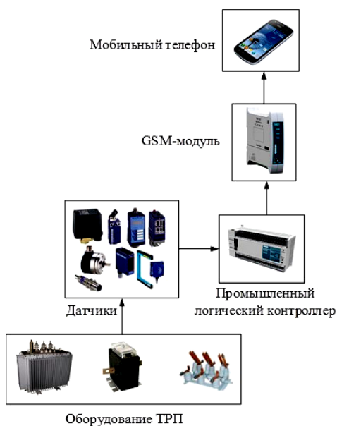
Рис. 1. Структурная схема системы удалённого мониторинга ТРП
