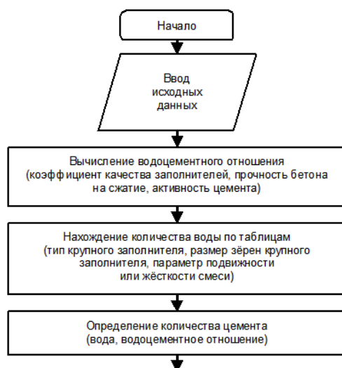
Рис. 1. Определение количества цемента и воды
