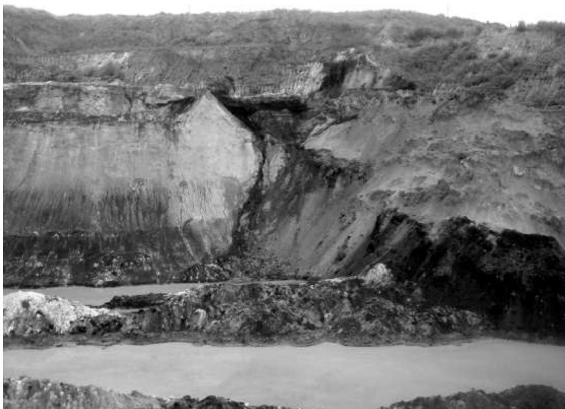
**Рис. 1. Промышленные пласты угля (черное) в забое Ушумунского бурогольного месторождения**
